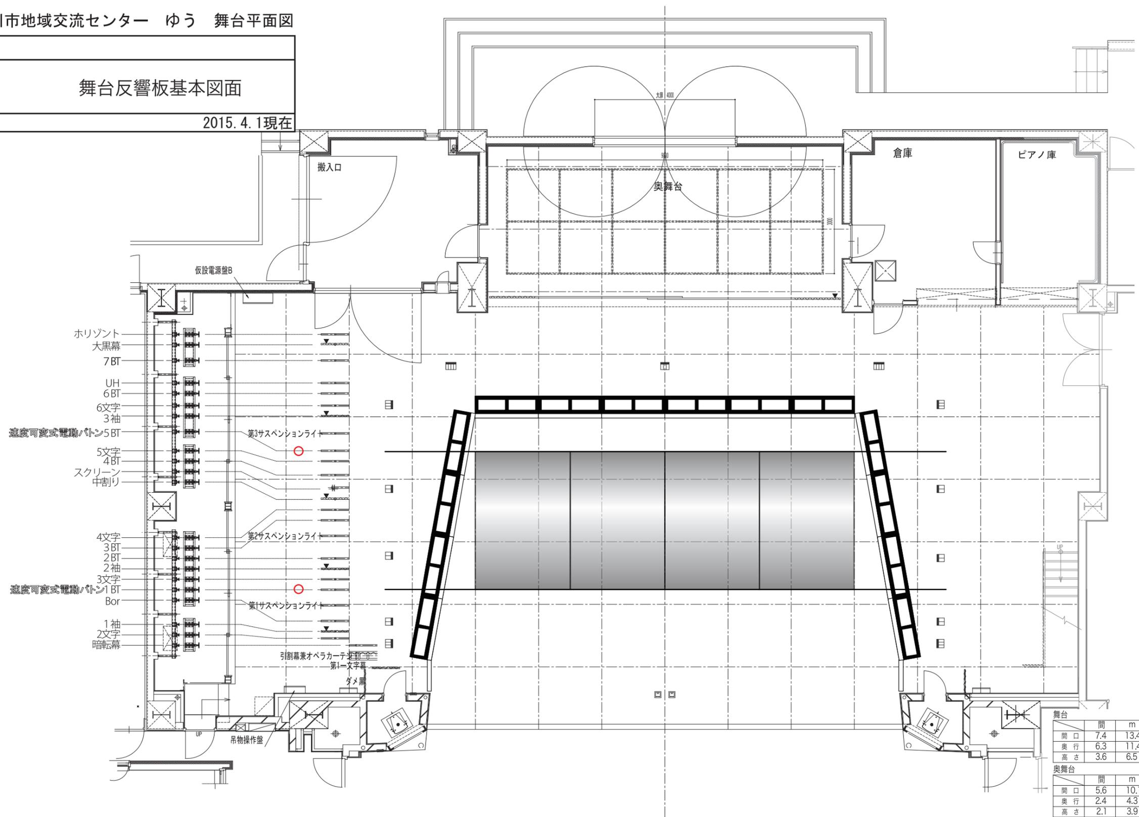
※2015年3月より「1BT」「5BT」を電動化しました。速度可変式で昇降します。
